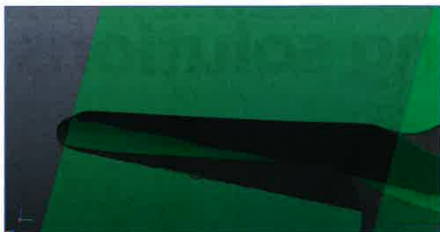
Abb. 3: Detail - Wendelquerschnitt der Kratzerschnecke mit Hinterschnitt 4 x 45°
