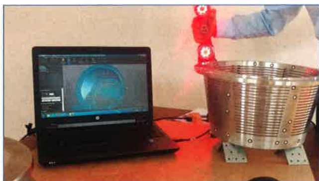
Abb. 1: 3dLaserScan-Verfahren zur hochpräzisen, mobilen Vor-Ort-Vermessung von Komponenten
