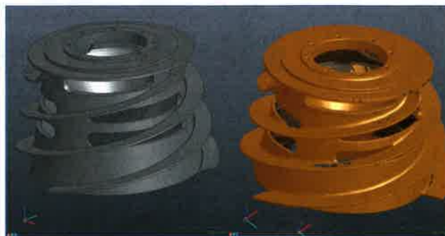
Abb. 4: Gegenüberstellung der Aufmessung mit dem CAD-Modell der Kratzerschnecke
